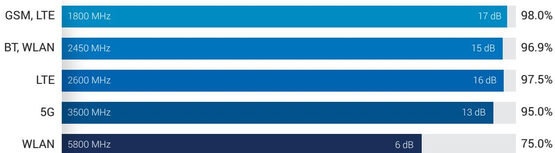
Messungen belegen die gute Abschirmleistung: Die Dämpfung hochfrequenter Strahlung in dem Frequenzbereich, der besonders von gepulsten Signalen, z. B. von Mobilfunkmasten, betroffen ist, beträgt 95 % bis 98 %. Auch statische und niederfrequente elektrische Felder, wie sie von Kabeln oder Geräten in Haushalten oder von Hochspannungsleitungen erzeugt werden, werden effizient gedämpft.
